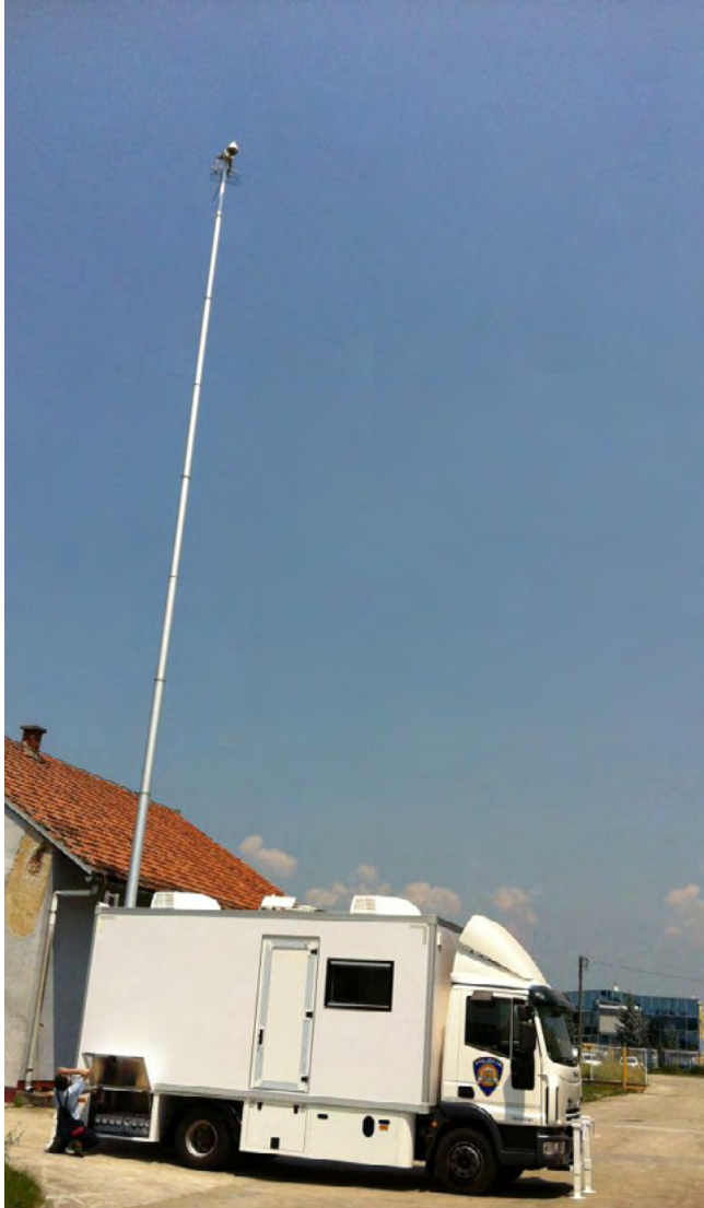
Kamera se može podignuti na visinu od 20 metara Camera may be elevated to 20-metre height
