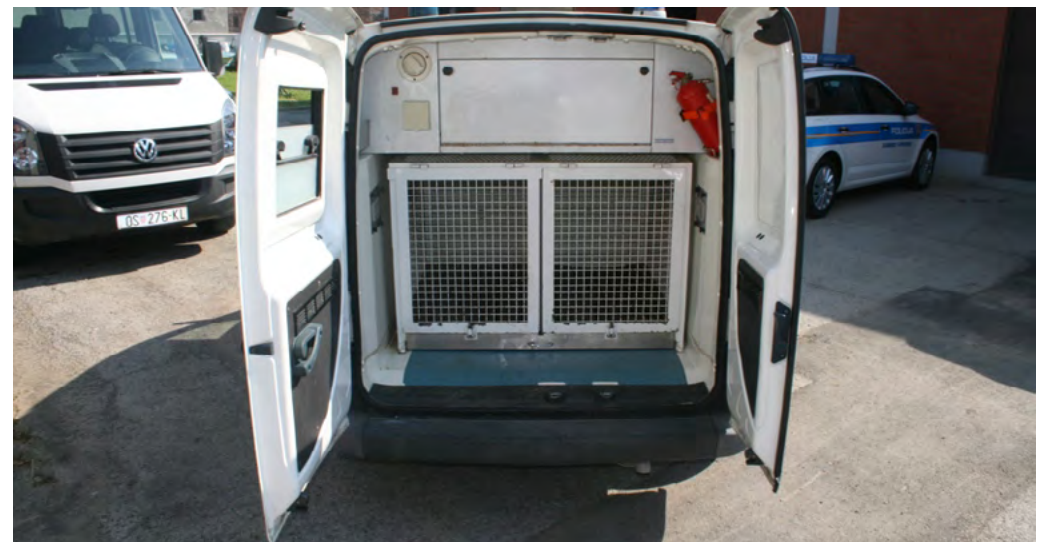
Teretni prostor vozila prilagođen je prijevozu službenih pasa Vehicle load compartment adjusted for service dog transportation
